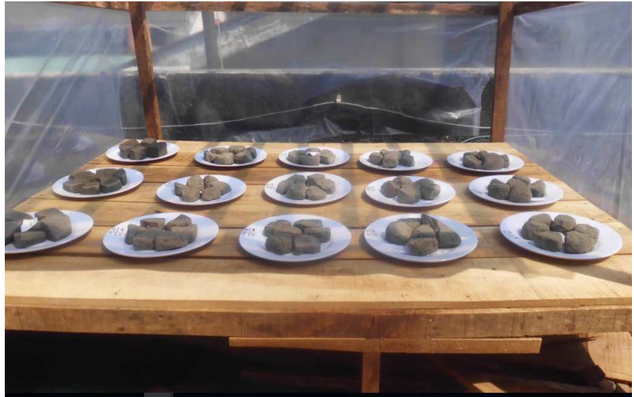
Gambar 4.1 Sampel clay shale Hambalang lapuk yang dibuat dengan variasi 3 kadar air dan tambahan 0%, 3%, 6%, 9% dan 12% PC dalam ruang pengeringan
