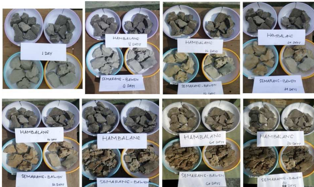
Gambar 2.8 Perubahan butiran clay shale Semarang-Bawen dan Hambalang akibat proses pengeringan hingga 80 hari, Atlas I.M.,(2017).
