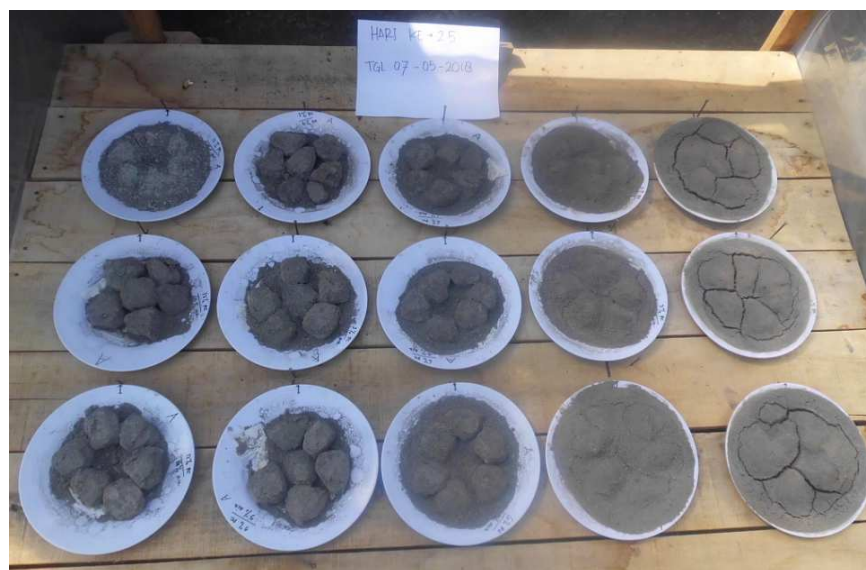
Gambar 4.8 Sampel clay shale Hambalang lapuk yang dibuat dengan variasi 3 kadar air dan tambahan 0%, 3%, 6%, 9% dan 12% PC hari ke 25 pengeringan (5x siklus pembasahan)
