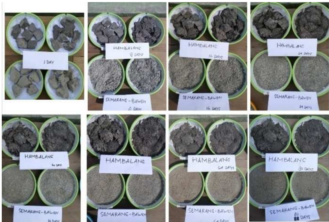
Gambar 2.11 Perubahan bentuk fisik clay shale Semarang-Bawen dan Hambalang akibat siklus pembasahana pengeringan dengan 2 kali pembasahan setiap 8 hari (Alatas I.M.,(2017).
