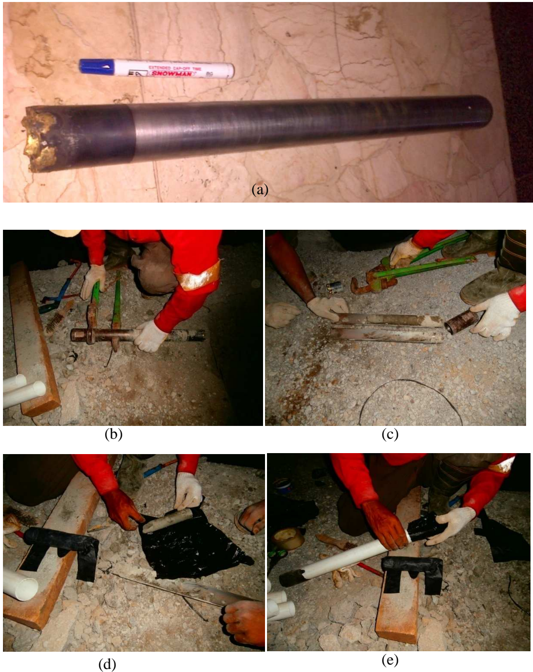
Gambar 3.3 Pengembangan acuan teras yang boleh terbelah ( split single core barrel ) (a), pelepasan kepala acuan teras (b), hasil sampel clay shale (c), sampel clay shale dibalut plastik hitam (d), sampel clay shale dimasukkan dalam PVC siap dihantar ke laboratorium (e).
