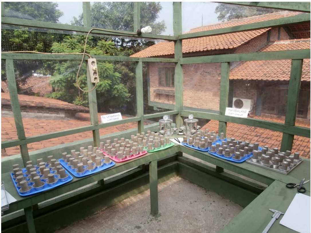
Gambar L 2 Uji perubahan berat isi pada proses pengeringan dan ruang pengeringan
