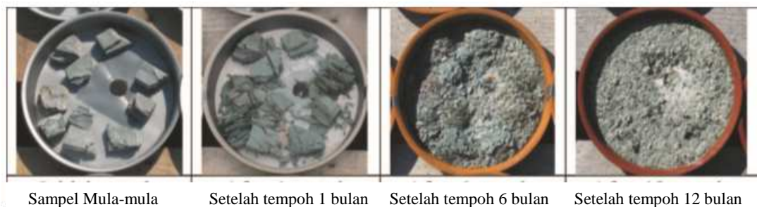
Gambar 5.7 Disintegritas sampel batuan lempung, setelah pendedahan iklim mula-mula (Shakoor dan Gautam, 2015)
