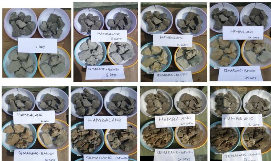
Gambar 5.2 Perubahan butiran clay shale Semarang-Bawen dan Hambalang akibat proses pengeringan hingga 80 hari
