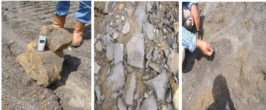
Gambar 1.3 Perubahan bentuk fisik clay shale dari masa ke masa (Irsyam et al. , 2011)
