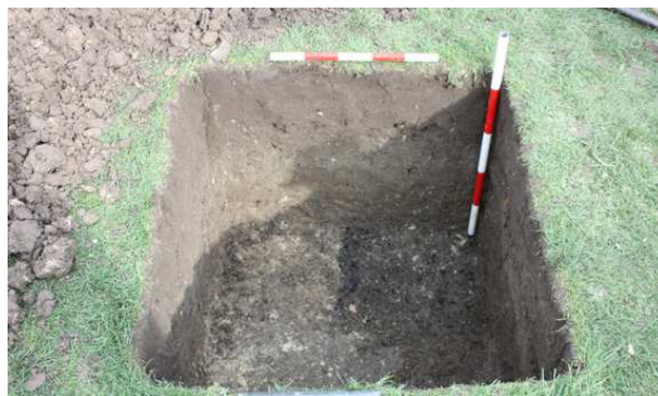
Gambar 2.4 Lubang Galian untuk Test Pit
