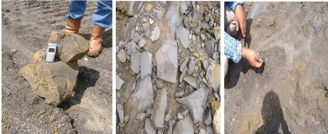
Gambar 1.2 Perubahan bentuk fisik clay shale dari masa ke masa (Irsyam et al. , 2011)
