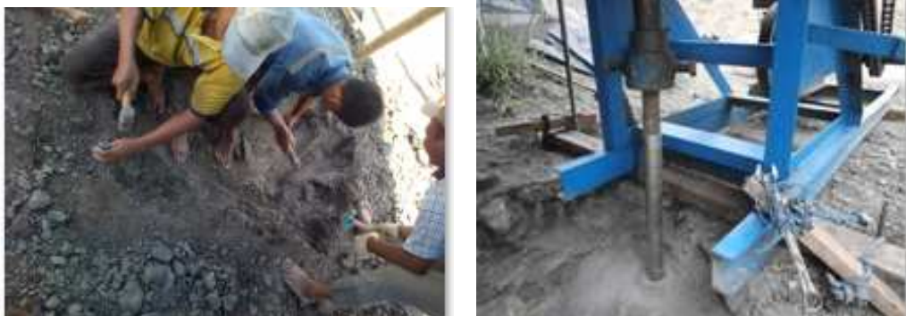
Gambar 4.5 Uji coba pertama kali pengambilan sampel clay shale dengan single core barrel dan standard mesin pengeboran penyelidikan tanah
