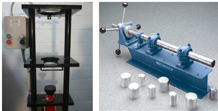
Gambar 2.7. Alat bantu pengeluaran sampel (ejector sampler) arah horizontal dan vertical dari shelly tube thin walled sample
