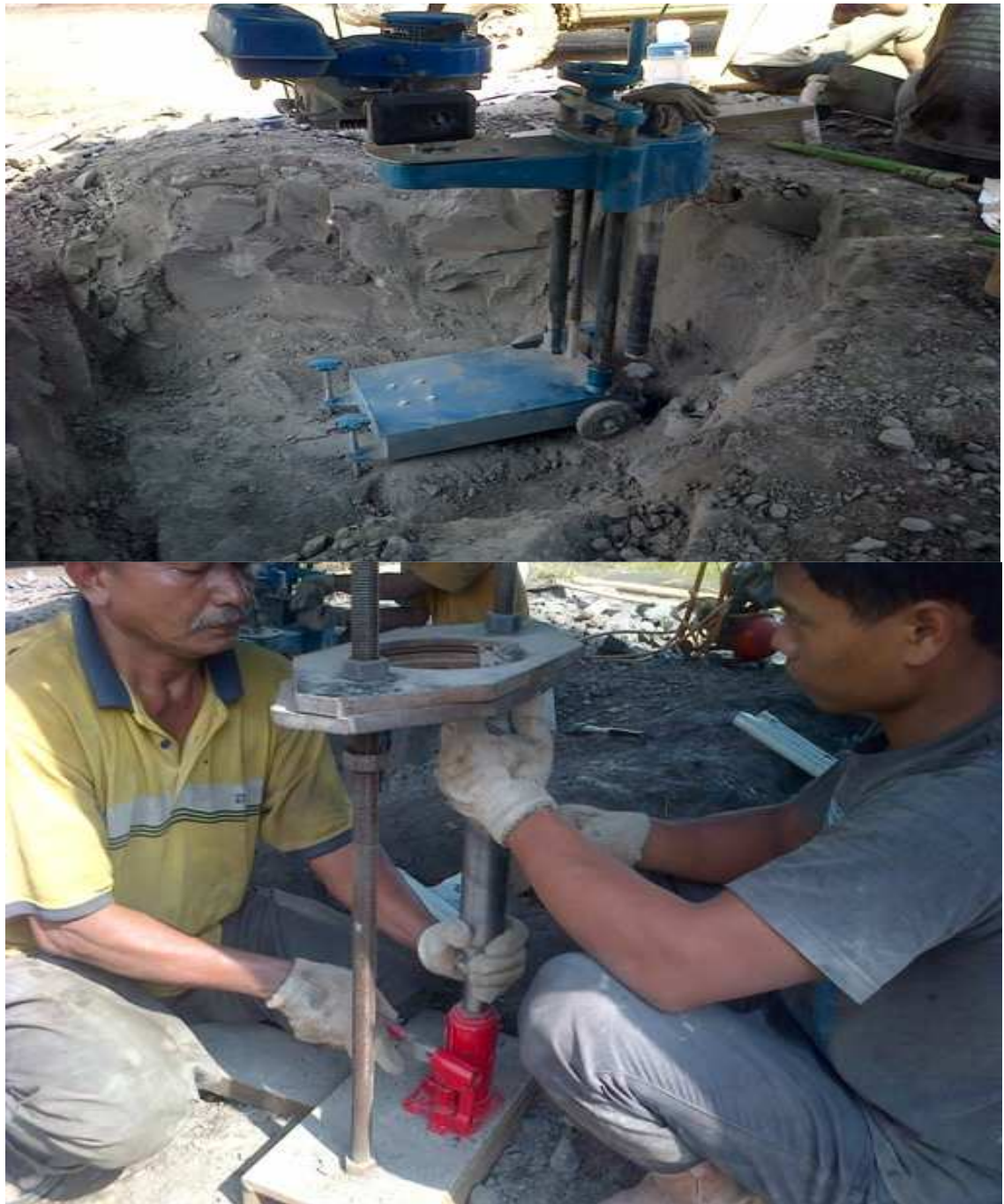
Gambar 3.4 Pengambilan sampel clay shale dengan metode lama menggunakan single core barrel, dan mengeluarkannya dengan bantuan alat ejector sample
