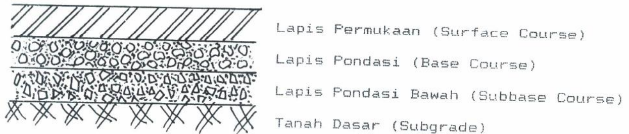
Gambar 2.4. Susunan Lapis Konstruksi Jalan
