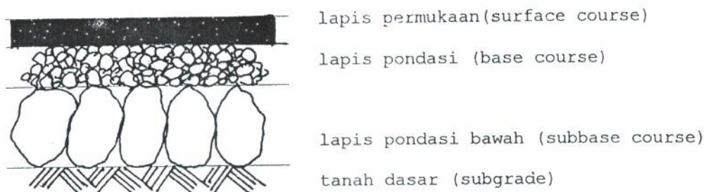
Gambar 2.4. Susunan Lapis Kontruksi Jalan
