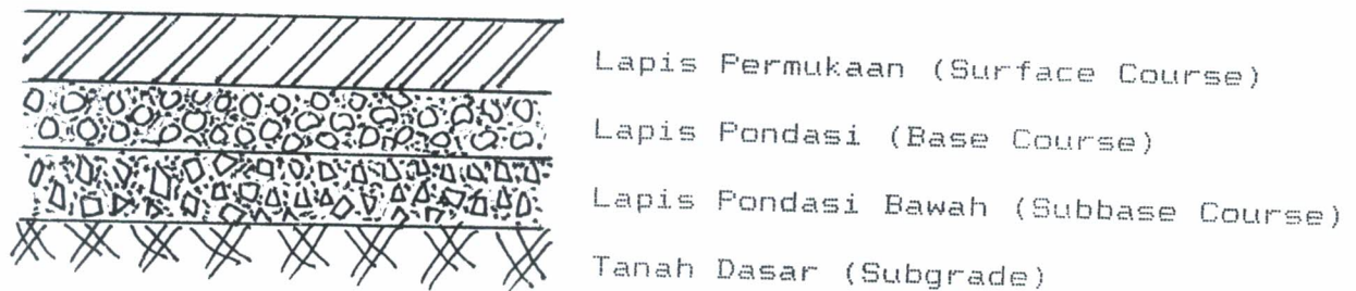
Gambar 2.4. Susunan Lapis Konstruksi Jalan
