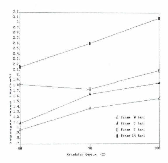
Gambar 4.4. Grafik hubungan antara Kepadatan gypsum dan Kohesi setelah distabilisasi dengan kolom gypsum dengan cara Analitis.
