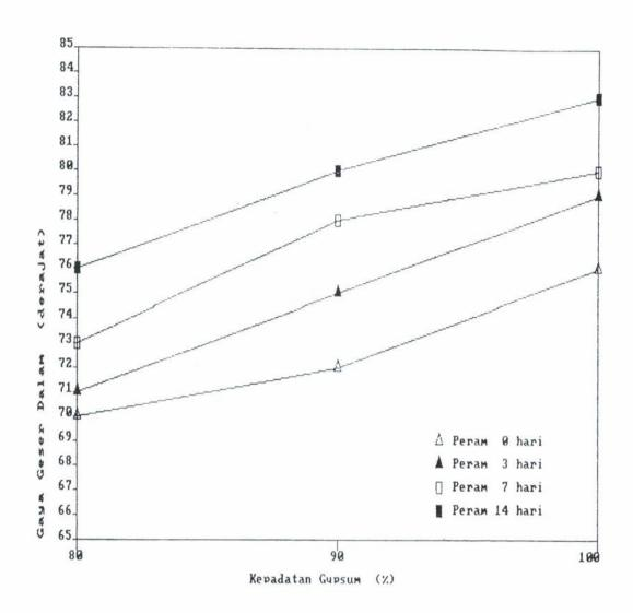
Gambar 4.6. Grafik hubungan antara Kepadatan gypsum dan Gaya geser dalam setelah distabilisasi dengan kolom gypsum dengan cara Analitis.
