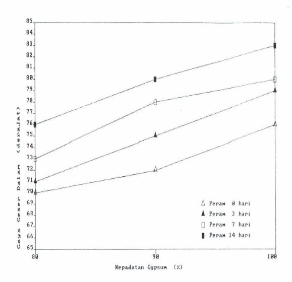
Gambar 4.7. Grafik antara Kepadatan gypsum dan Gaya geser dalam setelah distabilisasi dengan kolom gypsum dengan cara Grafis.
