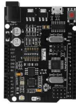
Gambar 1. Arduino Uno R3
