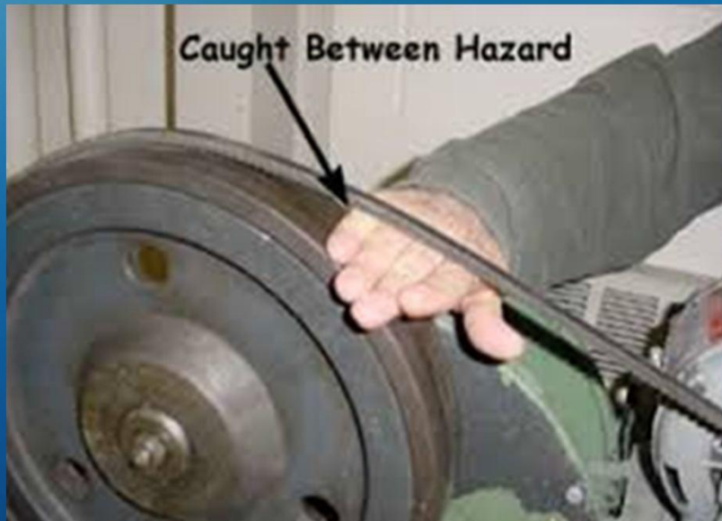
Mesin transmisi (pulley) tanpa Safety Devices → accident
