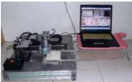
Gambar 4.1 Mesin mini CNC router 3 axis dengan menggunakan software mach 3
