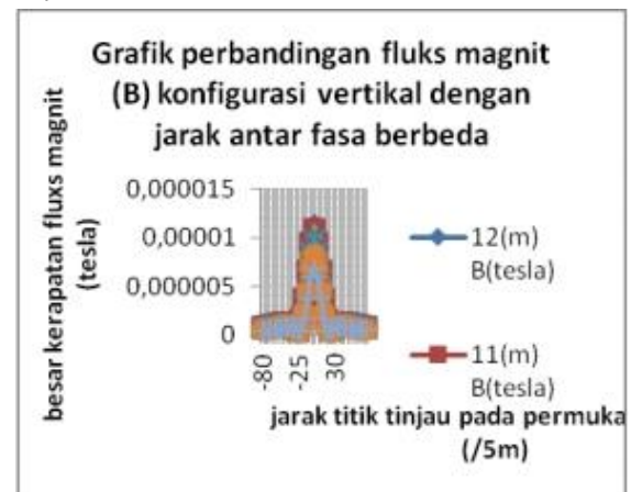
Gambar 4.9. Perbandingan kerapatan fluks magnet (B) konfigurasi vertikal
