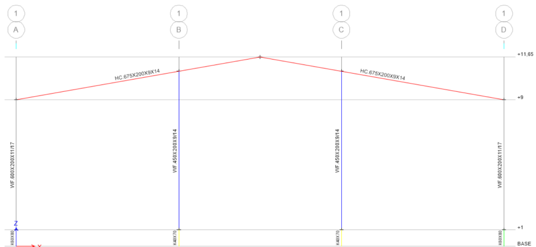
Gambar 2.77. Kolom Post Sudah Terhubung dengan Rafter
