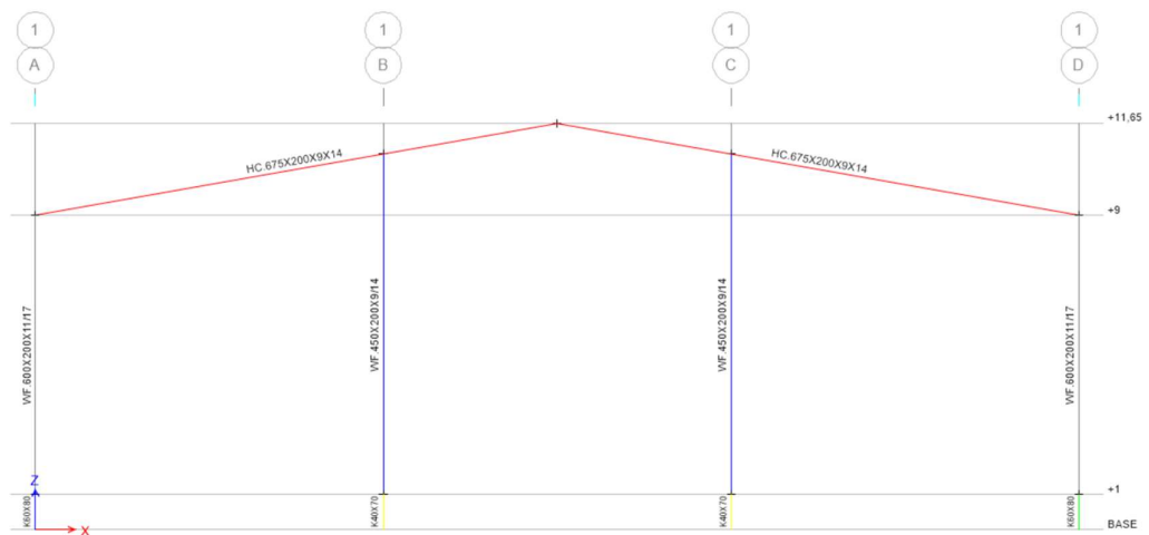
Gambar 2. 77. Kolom Post Sudah Terhubung dengan Rafter
