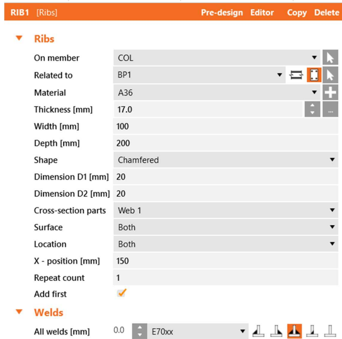
Gambar 6. 58. Pengaturan Properti Pelat Rib
