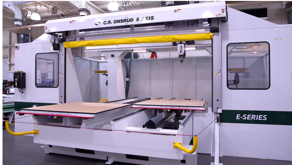
Gambar-14. Mencoba program tanpa benda kerja
