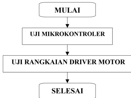
**Gambar 4.1. Alur Pengujian Perangkat Keras**
