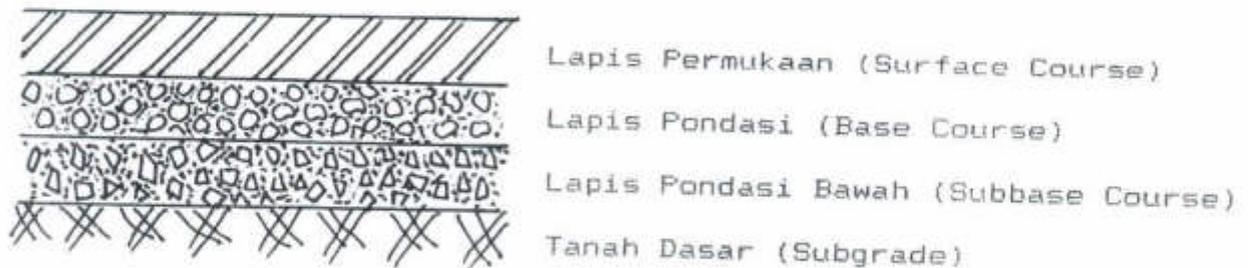
Gambar 2.4. Susunan Lapis Konstruksi Jalan
