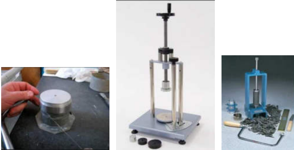
Gambar 2.8 Pencetakan silinder sampel untuk test konsolidasi/ direct shear serta pencetakan uju sampel tri-axial
