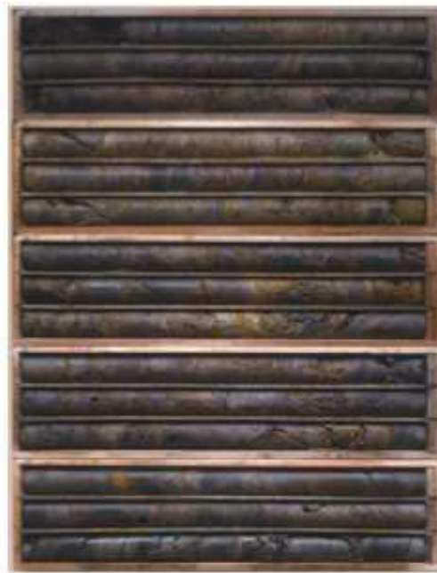
Gambar 2.6. Sampel coring yang telah ditempatkan di core box
