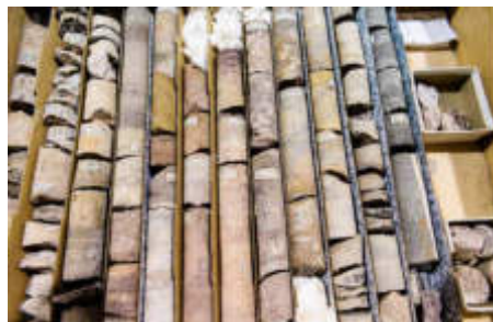
Gambar 2.9. Hasil uji coring pada batuan
