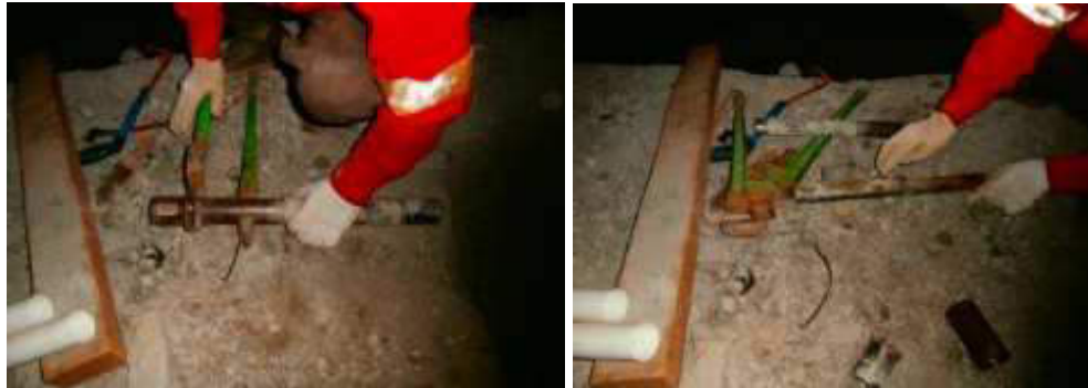
Gambar 4.14 Proses pengeluaran clay dari split single core barrel di Semarang-Bawen
