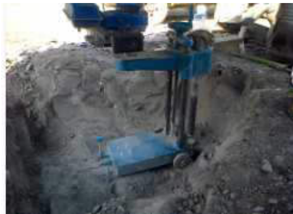
Gambar 4.8. Uji coba pengeboran dengan high speed drilling machine dengan menggunakan single core barrel di Hambalang.
