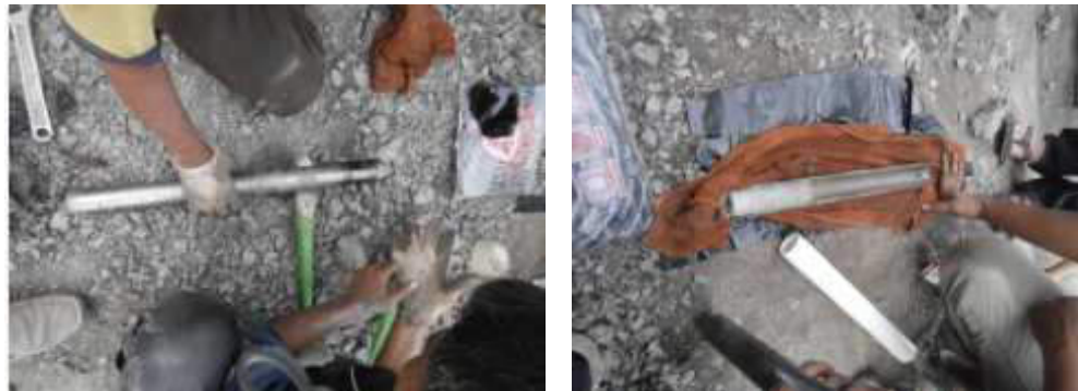
Gambar 4.9 Pembukaan Bata Bor dari split single core barrel dan sampe yang didapat dari split single core barrel
