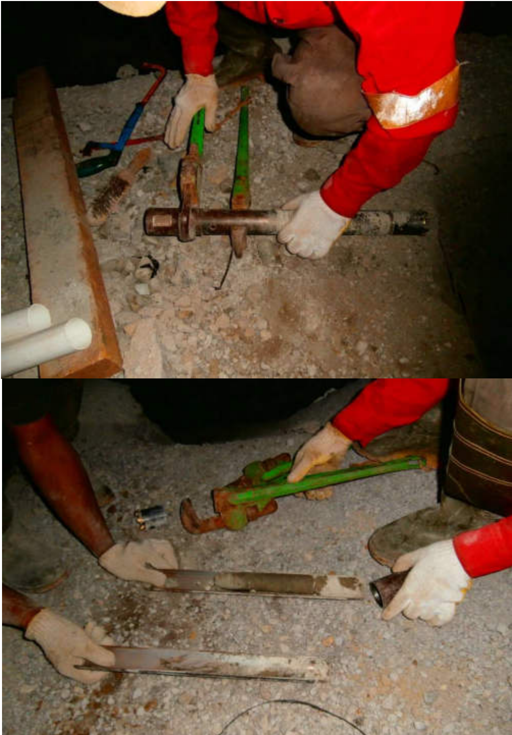
Gambar 3.5 Pengeluaran sampel clay shale dengan bor barrel yang bisa terbelah ( split single core barrel ), lebih mudah, lebih cepat, dan lebih aman bagi sampel clay shale.
