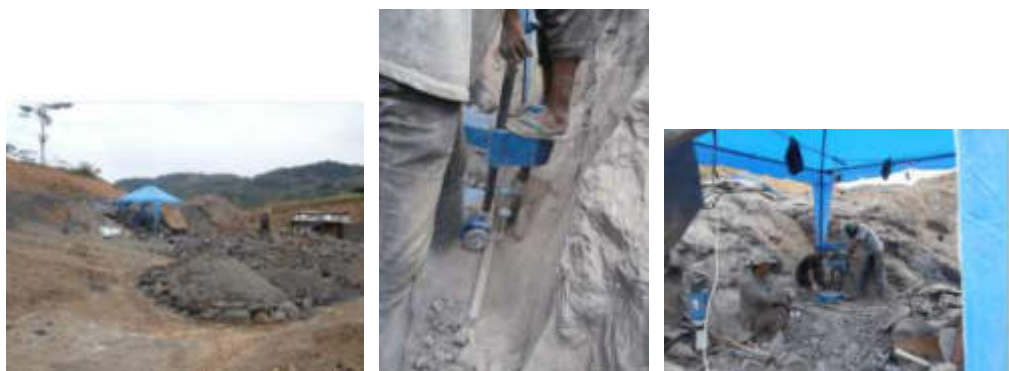
Gambar 4.10. Pengambilann sampel clay shale di Hambalang dengan split single core barrel dan high speed drilling core machine .
