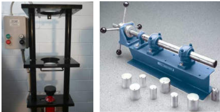
Gambar 2.7. Alat bantu pengeluaran sampel (ejector sampel) arah horizontal dan vertical dari shelly tube thin walled sample
