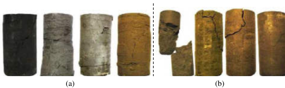
Gambar 2.8 Gambar keruntuhan sampel (a) Marl Taylor dan (b) Shale Navarro selepas uji triaksial tahap berbilang (Youn dan Tonon, 2010)
