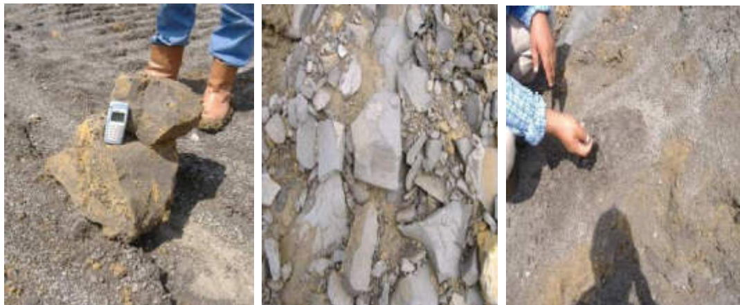
Gambar 1.4 Perubahan bentuk fisik clay shale dari masa ke masa (Irsyam et al. , 2011)
