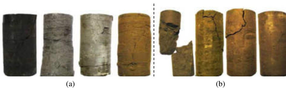
Gambar 2.12 Gambar keruntuhan sampel (a) Marl Taylor dan (b) Shale Navarro selepas uji triaksial tahap berbilang (Youn dan Tonon, 2010)
