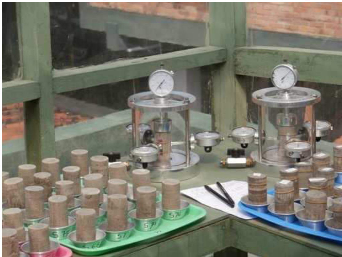
Gambar 3.10 Hasil sampel tak terganggu clay shale Semarang-Bawen dan Hambalang di dalam ruang pengeringan
