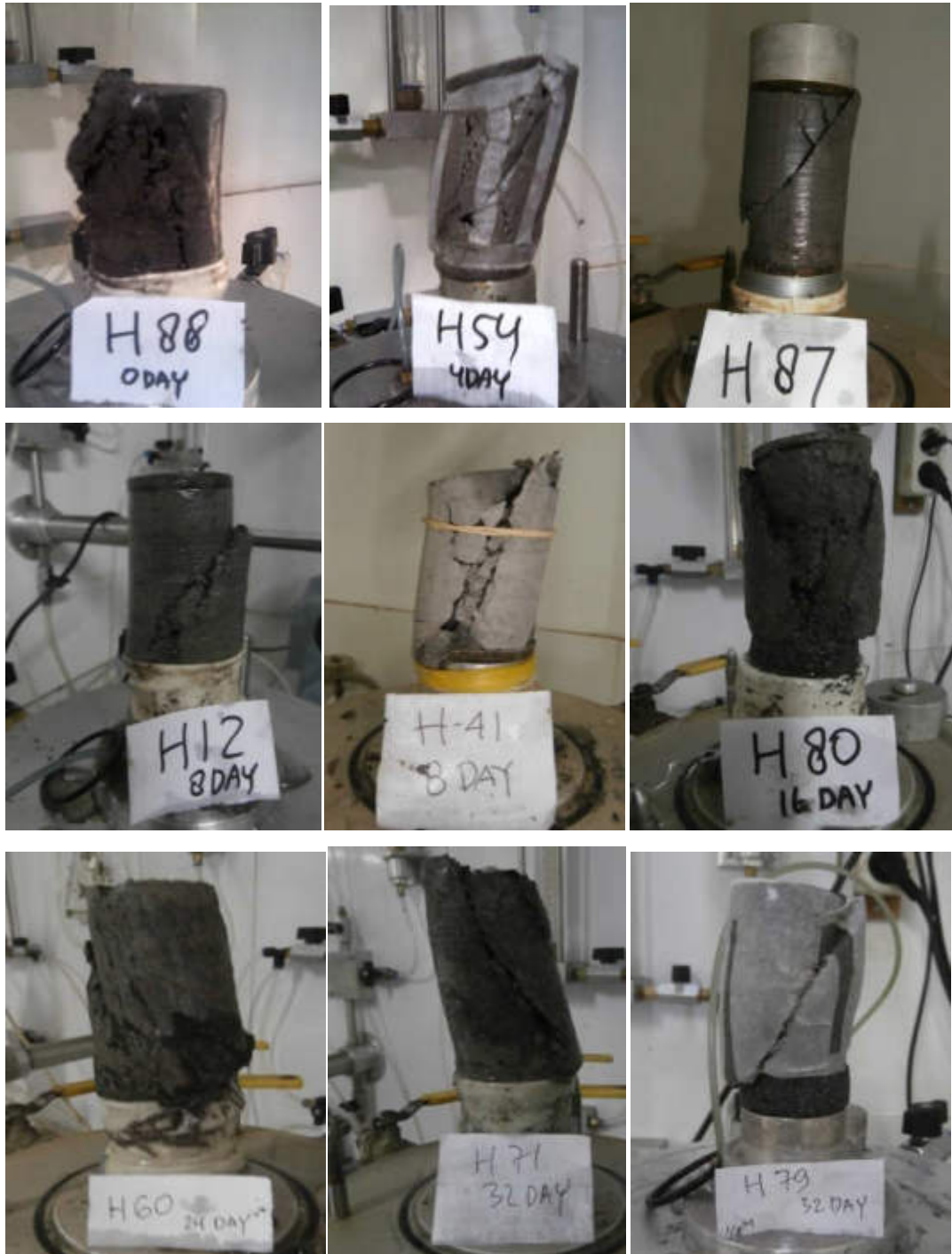
Gambar 4.22 Gambar sudut joint hasil penelitian clay shale Hambalang tak jenuh dan jenuh dari triaksial di laboratorium (sampel 0 hari hingga 32 hari)
