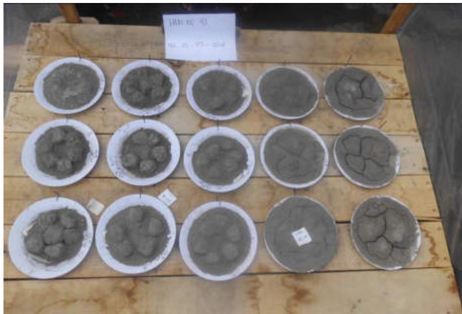
Gambar 4.12 Sampel clay shale Hambalang lapuk yang dibuat dengan variasi 3 kadar air dan tambahan 0%, 3%, 6%, 9% dan 12% PC hari ke 41 pengeringan (9x siklus pembasahan)
