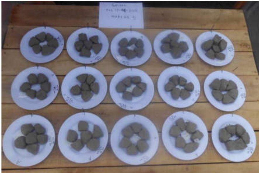
Gambar 4.3 Sampel clay shale Hambalang lapuk yang dibuat dengan variasi 3 kadar air dan tambahan 0%, 3%, 6%, 9% dan 12% PC hari ke 9 pengeringan
