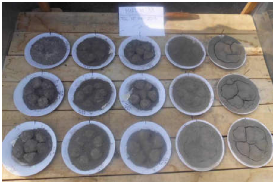
Gambar 4.10 Sampel clay shale Hambalang lapuk yang dibuat dengan variasi 3 kadar air dan tambahan 0%, 3%, 6%, 9% dan 12% PC hari ke 33 pengeringan (7x siklus pembasahan)
