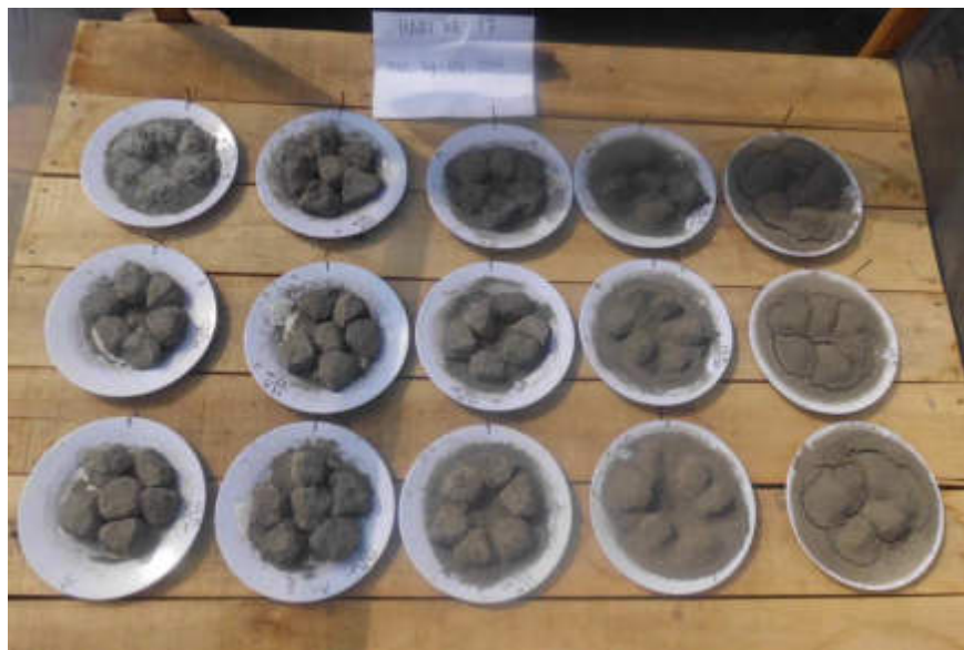
Gambar 4.6 Sampel clay shale Hambalang lapuk yang dibuat dengan variasi 3 kadar air dan tambahan 0%, 3%, 6%, 9% dan 12% PC hari ke 17 pengeringan (3x siklus pembasahan)
