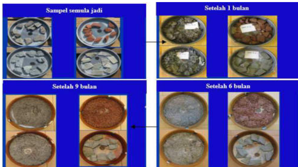
Gambar 2.5 Perubahan fisik clay shale dan lainnya akibat pelapukan (Shakoor dan Tej, 2011)
