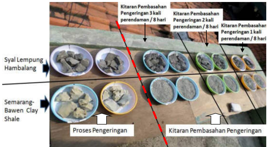
Gambar 2.7 Perubahan sifat fisik clay shale Semarang-Bawen dan Hambalang terhadap proses pengeringan dan siklus pembasahan pengeringan, Atlas I.M.,(2017).
